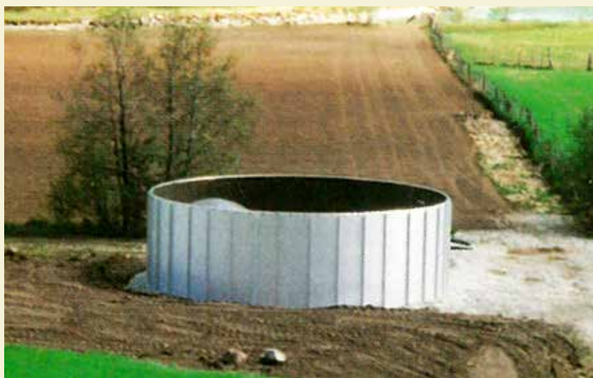
Tank med stålplateveggar og innvendig armert duk. Tanken kan demonterast og flyttast, etter måten, enkelt. Den vert levert i høgder på 4 og 3 meter og kan utstyrast med dekke for å halde nedbøren unna. Foto: «Hansen Protection»
