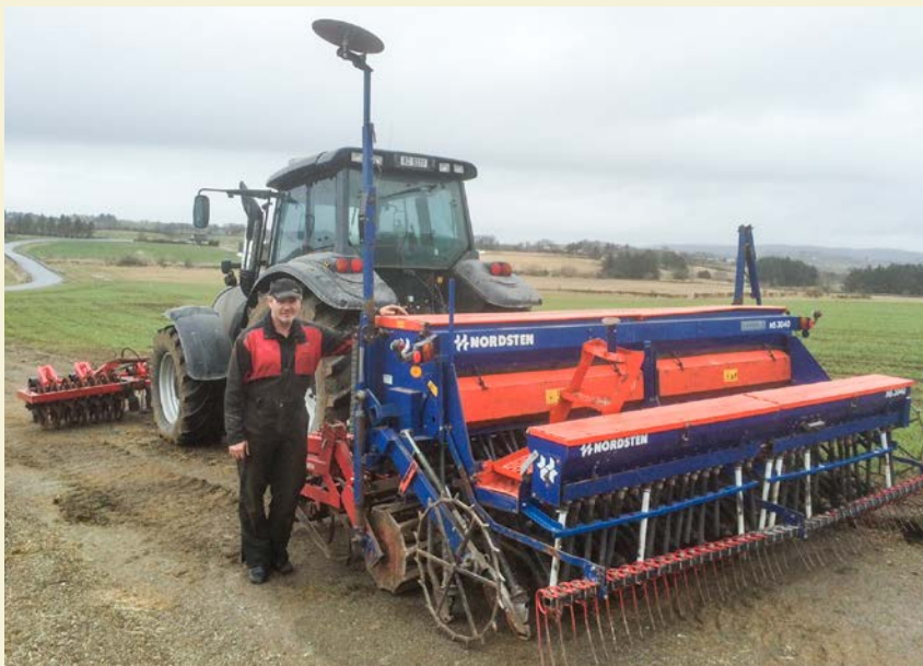
Tor Torland presenterer her kombiset; slåddelank-S-tindharv-pakketrommel (pakker stein), såmaskin for korn/gras og etterharv. Foto: Ragnvald Gramstad.
