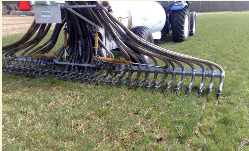
Grunn nedfelling gir mindre tilgrising og stor nøyaktighet. Foto: Sverre Heggset.
