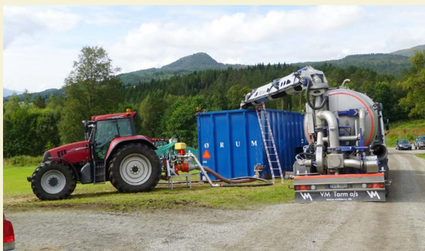
Langtransport av husdyrgjødsel til mellomlager, spredning med slangespreder.
