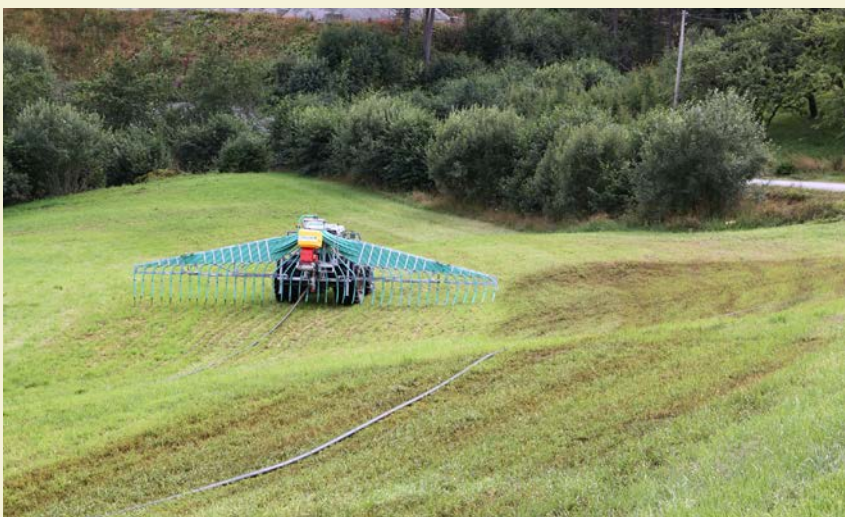
Kombinasjonen slange og stripesprederbom gir stor nøyaktighet og stor kapasitet. Foto: Sverre Heggset.
